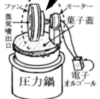
図6 火力発電原理説明器
